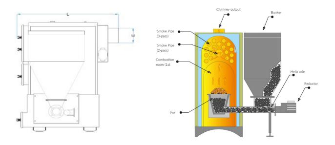
\*CHIMNEY CONNECTION FOR KM 80 AND OVER IS AS SHOWN IN THE FIGURE.
